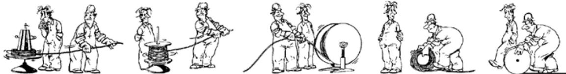
Korrekt udtagning af ståltov fra kvejl og tromle / Correct ways to remove steel wire rope from a coil or reel.
