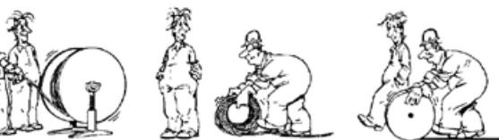
Korrekt udtagning af ståltov fra kvejl og tromle / Correct ways to remove steel wire rope from a coil or reel.
