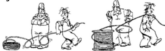
Forkert udtagning af ståltov fra kvejl og tromle / Incorrect ways to remove steel wire rope from a coil or reel.
